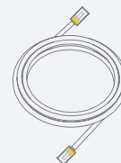
Câble pour la communication Ethernet et boîtier d'entrée intelligent : CAT6, T568B direct, blindé, marqué STP ou SFTP
